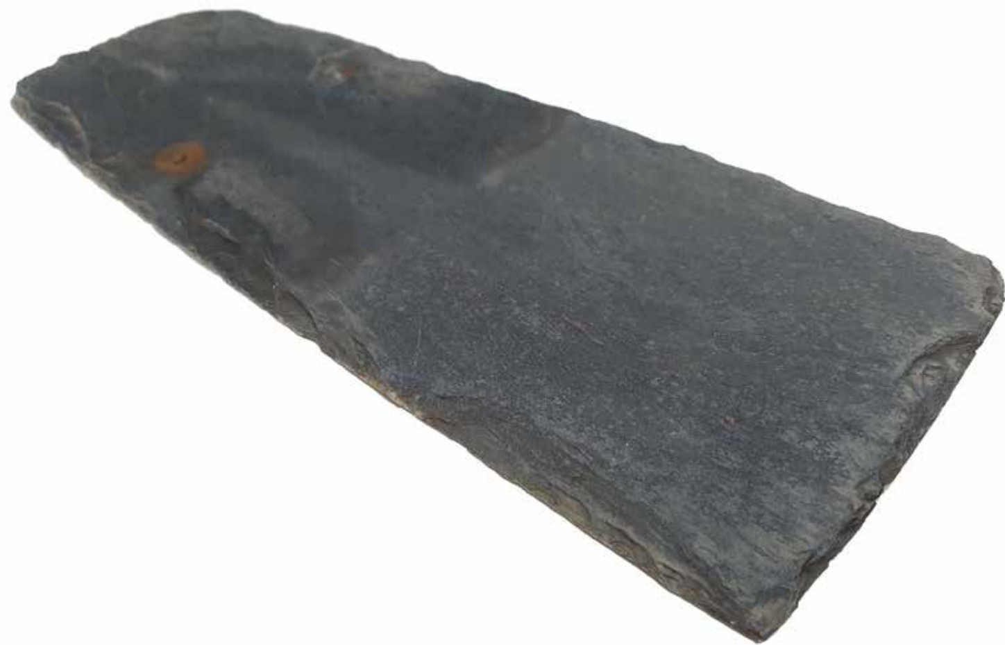
Imagen I-16. Pizarra recuperada del monasterio de El Escorial con aproximadamente 300 años desde que fue fabricada. dimensiones de la conocida Medida Real 40x15.
